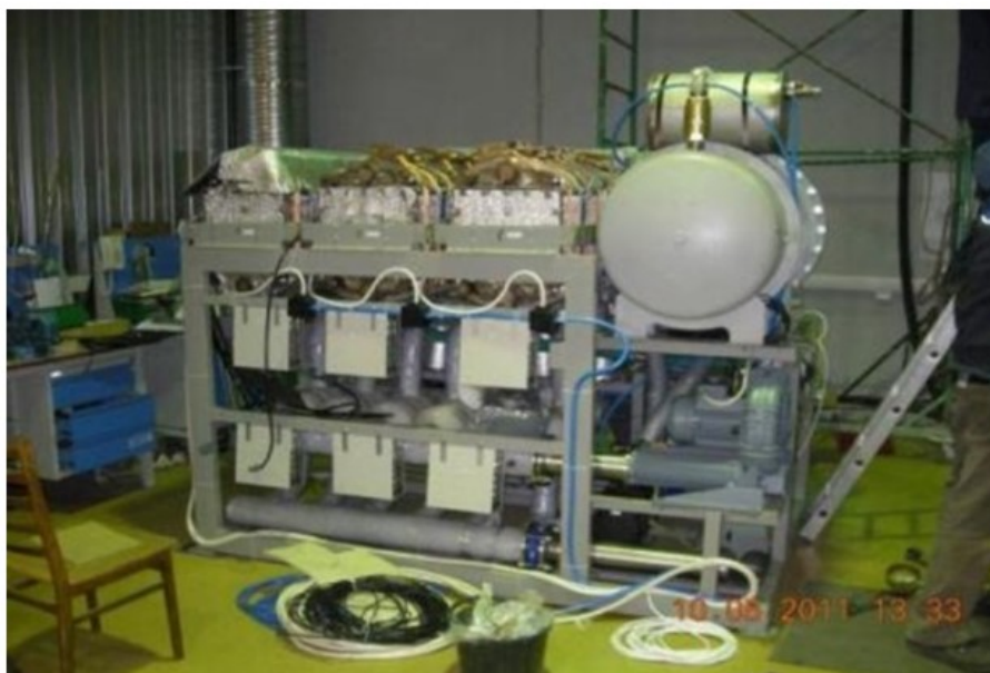
Рисунок 7 — Судовая гибридная энергетическая установка на основе батарей БТЭ-84 мощностью 60 кВт/. Фото ЦНИИ СЭТ
